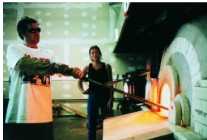
Hans-Joachim Ittig am Ofen bei der Glasentnahme mit der Glasmacherpfeife
