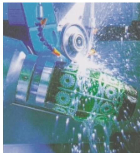
Automatisches Abziehen von Schleifscheiben ermöglicht stets geschärfte Schleifscheiben und liefert deshalb immer gute Schleifresultate Bild: Proglas
