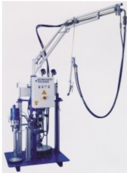
Dosier- und Mischanlage „S97“ als pneumatische Version für die Isolierglasfertigung
