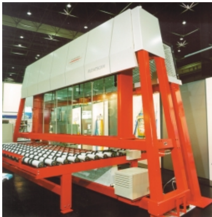
Glasfehlerdetektion mit „Floatscan-Catcher“
