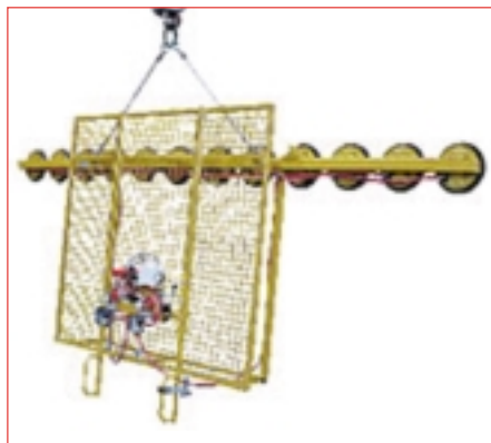
Vakuumhebergerät, das teilweise die Anforderungen aus der Vornorm prEn 13035-1 erfüllt Bild: Pannkoke.
