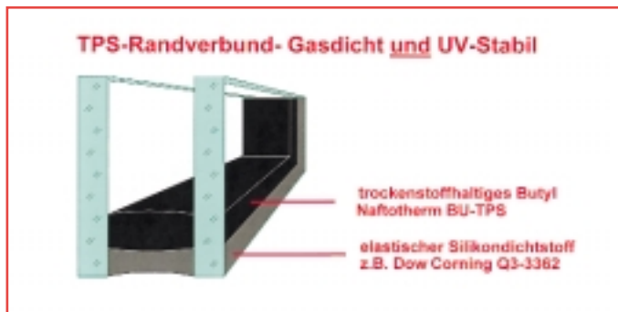
Bild 5: Beispiel eines gasdichten und UV-stabilen TPS-Randverbund
