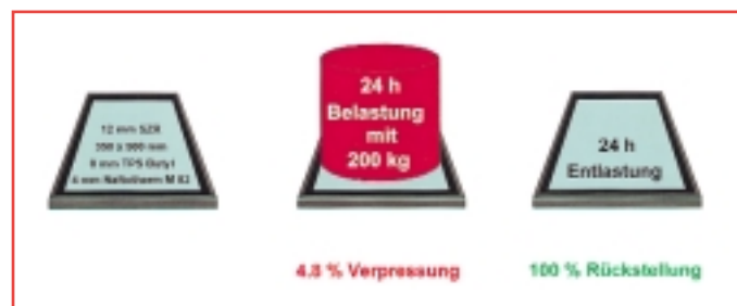
Bild 7: Mechanische Belastung einer TPS-Isolierglaseinheit im Test
