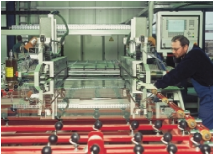
Schleifanlage für Rechteckscheiben zur Herstellung von flachfeinen und polierten Kanten
