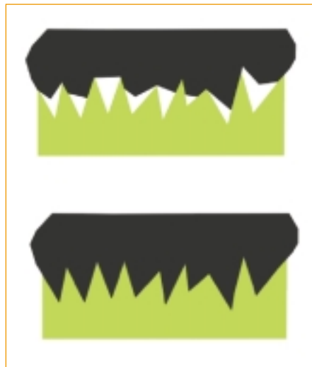
Bild 5: Butylschnur schnell und langsam verpreßt Bilder: Huntebrinker
