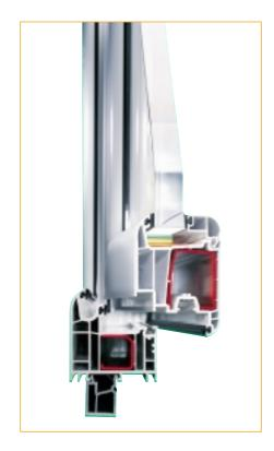
Es ist also sichergestellt, daß Dreh-Kipp-Fenster, von außen und innen abschließbare Balkontüren, breite Abstell-Schiebe-Kipptüren und Haustüren gefertigt werden können, letztere mit einer speziellen, geschweißten Stahlrohr-Aussteifung von 50 × 50 × 2 mm. Für Stulp-Fenster sind Stulpleisten im Programm, die einen mittigen Olivensitz ermöglichen. Runde Sprossen ergänzen das Profilsortiment.
