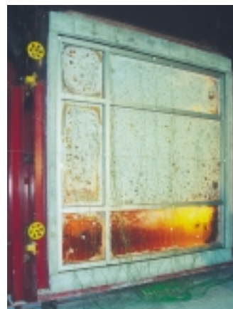
Mit ansteigender Temperatur, verändern sich die klaren Gläser zu einem undurchsichtigen Hitzeschild
