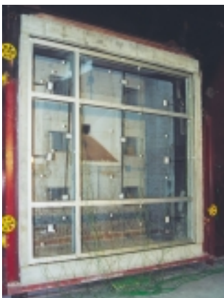
Die F30 Verglasung mit dem Brandschutzglas „Fewadur“ und den Plates die gut zu erkennen sind
