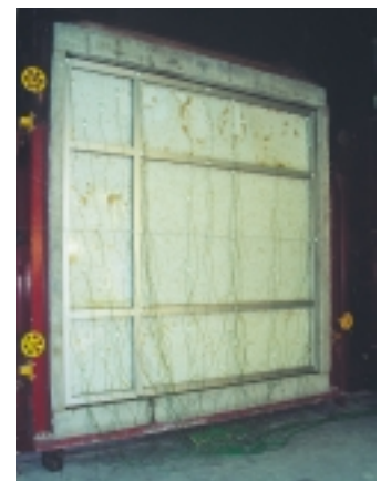
Auch nach 35 Minuten Prüfungsdauer, ist der Hitzeschild noch in einwandfreiem Zustand
