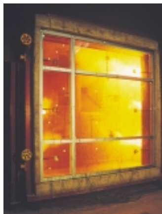
Die Ölbrenner liefern die Ofentemperatur gemäß der Einheits-Temperatur-Zeitkurve (ETK)
