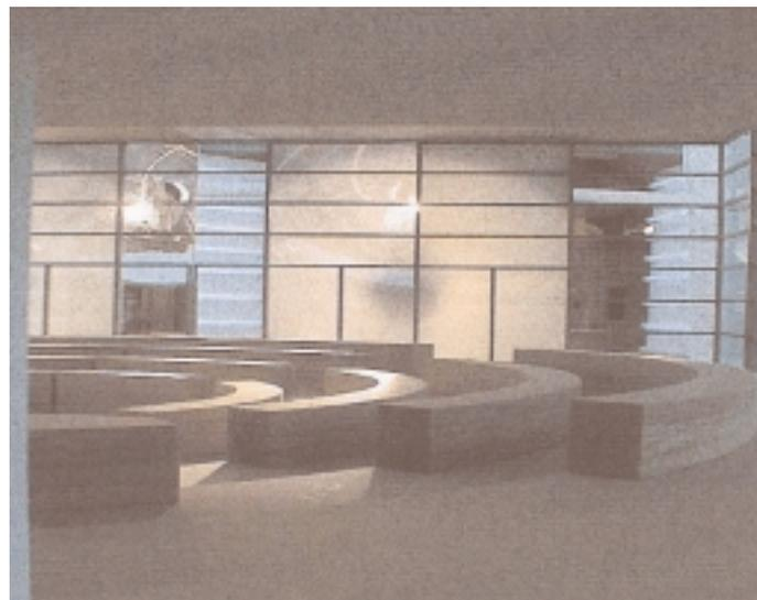
Bild 8: Innenraumaufnahme des Kieler Plenarsaales im Modell. Hier wurden die Reflexionsbedingungen in Abhängigkeit der verwendeten Materialien exakt nachgestellt
