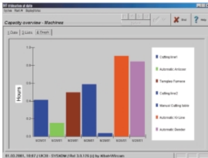
Bild 3: Graphische Kapazitätsübersicht über verschiedene Maschinen für einen definierten Zeitbereich
