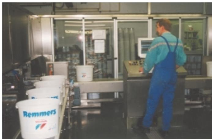
*Kürzere Lieferzeiten und konstante Qualitäten bringt die neue In-Can-Dosieranlage von Remmers, die Gebindegrößen von 2,5 bis 120 Liter auf 0,1 Gramm genau abfüllen kann*
