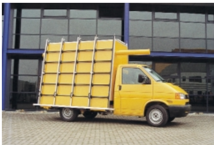
„Euroborn“- Aluminium- Glas-Reff für geschlossenen Aufbau mit Glas- leistenköcher Bild: Van den Born
