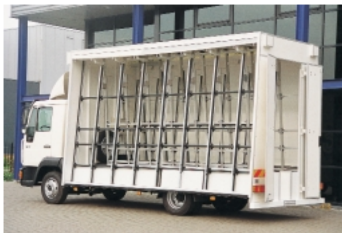
„Euroborn“- Aluminium- Glas-Reff für Nutzfahrzeuge mit Schiebeplane
