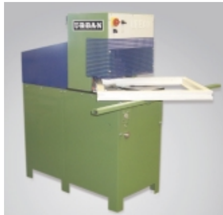
Die „SV A 2in1“ eignet sich gut für kleinere Betriebe, da sie sowohl verputzen, als auch ausklinken kann
