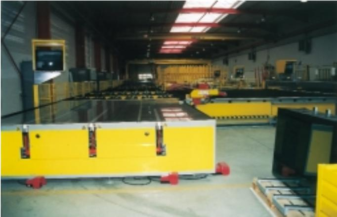
Die weltweit größte vollautomatische Universal-Glasschneideanlage, auf der von Dünnglas über Float bis hin zu VSG alles geschnitten werden kann
