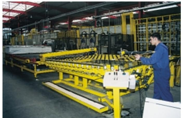
An der Rückseite der TPS-Anlage ist die moderne Gießharz-Durchlaufanlage angeschlossen
