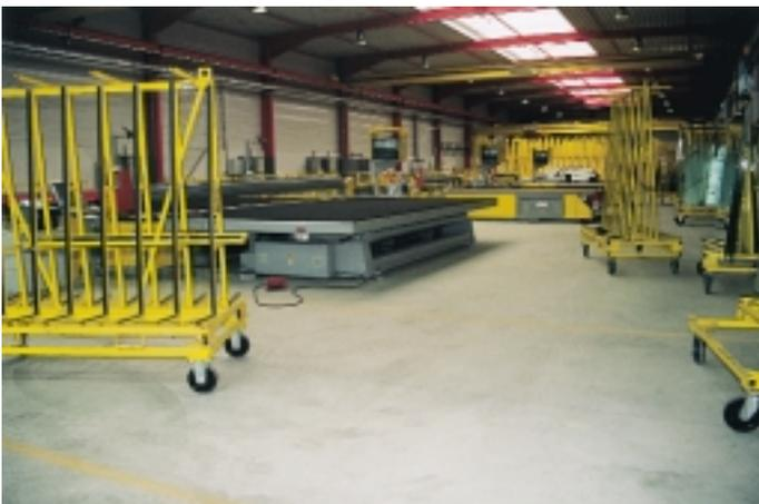
Hier – wie an allen der vier Kopfstationen – können VSG-Scheiben maßgenau zugeschnitten, gebrochen und abtransportiert werden
