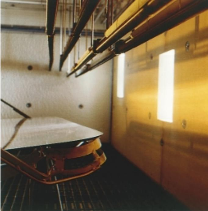
Der „LTFBA-Ofen“ ist mit vertikal verstellbaren Heizelementen, den VAHE (oben im Bild), ausgestattet. Diese sollen nicht nur den Energieverbrauch senken, sondern auch schnellere Arbeitszyklen ermöglichen
