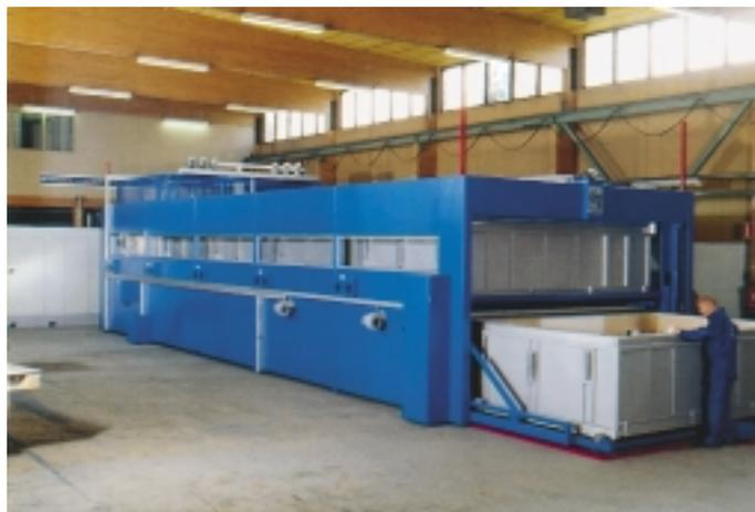
*Der Doppeltagen-Tunnelofen von Glassrobots hat zwei verschiedene Arbeitsbereiche: im oberen Bereich ist die Vorheizspur untergebracht, im unteren Teil die Abkühlspur. Sobald der Ofen mit Glas beschickt wird, führt die vollautomatische Steuerung das Glas durch die Vorheizzonen zur Biegestation und über die Abkühlspur zurück zur Beladestation (rechts im Bild)*
