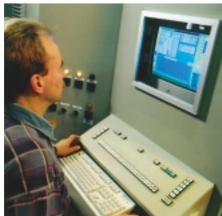
Ein PC verknüpft das System über eine windowsbasierte Grafik-Schnittstelle mit der Prozeßsteuerung und den Kontrollvorrichtungen
