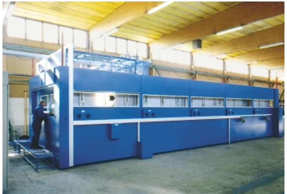
*Der Biegeofen „LFBA“ dient der Herstellung von großen Scheiben z. B. für Busse und Spezialfahrzeuge, und vereint die Vorteile eines vielseitigen Einkammerofens mit der Leistung und Kapazität eines Serien-Biegeofens*
