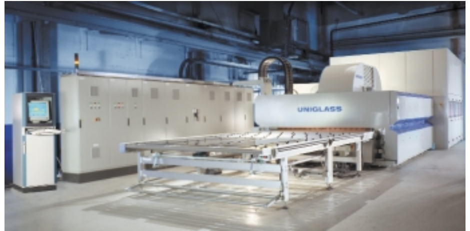
Hochwertige Glasprodukte lassen sich mit Hochkonvektionsöfen veredeln
