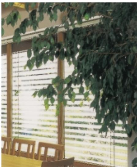
*Die Lamellen können manuell oder elektrisch, aber auch mit einem zentralen Steuergerät über Sensoren, Zeitsteuerung oder Lichtmesser bedient werden*
