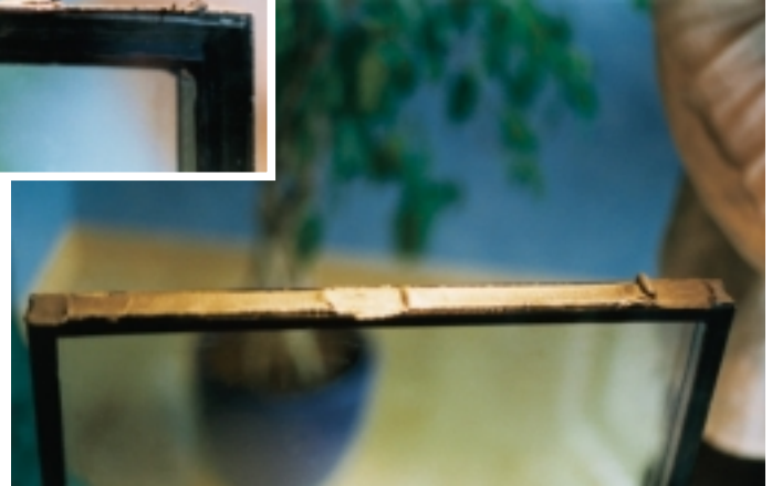
Bild 8: Bei einer sorgfältigen Herstellung der Isolierglasscheibe darf die Randabdichtung an den Außenkanten nicht vorstehen
