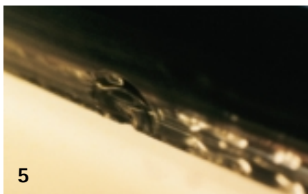
Bild 4: Auf der Innenseite der VSG-Scheibe ist eine muschelförmige Abplattung zu sehen, die durch eine erhebliche Stoß- oder Schlagbelastung erfolgt sein muß
