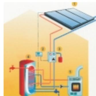
Die Komponenten der Solarthermie-Anlage: Kollektor (1), Solarregler (2), Pumpe der Solarstation (3), Wasserspeicher (4) sowie die vorhandene Heizung (5), die zugeschaltet werden kann
