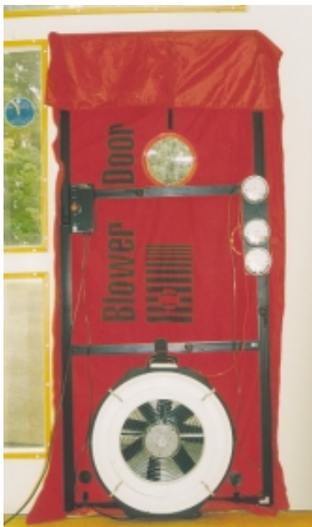
Bei der Blower-Door-Messung wird ein Ventilator luftdicht in die Öffnung der Eingangstür eingebaut
