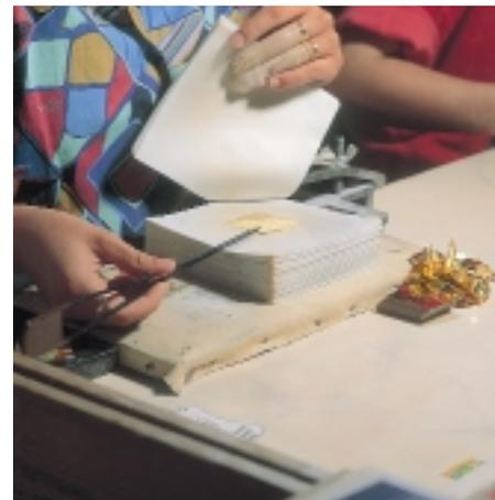
Eine Einfüllerin gibt bereits bis  $\frac{1}{1000}$  dünne Goldblätter mit einer Zurichterzange in die Schlagform für den dritten Schlagprozeß, bei dem die Blätter eine Dünne von bis zu  $\frac{1}{10\,000}$  mm annehmen, also noch um das 10fache verdünnt werden
