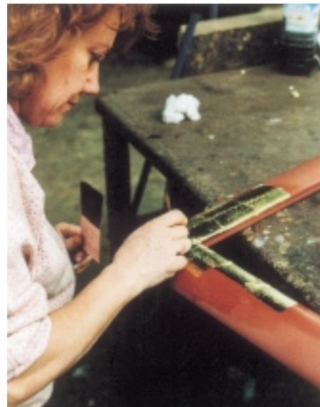
*Diese Vergolderin aus einer Rahmenmanufaktur in Frankreich vergoldet einen Rahmen, dessen Oberfläche mit rotem Poliment für die Vergoldung vorbereitet ist; in der linken Hand hält sie den Anschließpinsel, mit der rechten feuchtet („netzt“) sie die polimentierte Oberfläche an*
