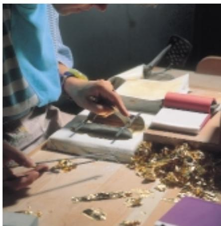
Auf dem Beschneidekissen schneidet die Beschneiderin die hauchdünne (Dünne bis  $\frac{1}{10\,000}$  mm) Goldfolie mit dem Beschneidekarren quadratisch, anschließend legt sie Blatt für Blatt mit der Beschneidezange zwischen je zwei Blätter eines 25seitigen Heftchens aus Seidenpapier (Büchlein)
