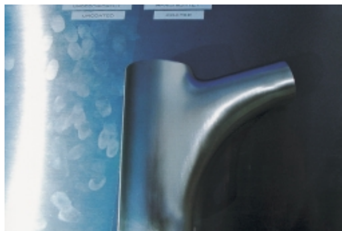
Anti-Fingerprint-Beschichtung auf glatten und geformten Edelstahloberflächen im Vergleich zur unbeschichteten Fläche
