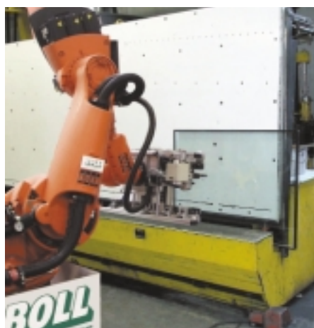
Die neue Roboteranlage ermöglicht eine automatische Isolierglasentnahme
