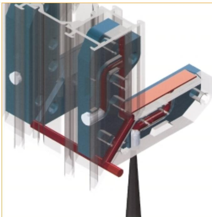
*Eine neue Injektionstechnik mit dosierter Kleberführung in definierten Kanälen erleichtert die saubere und rasche Verbindung von Eck- und Stoßverbindern*
