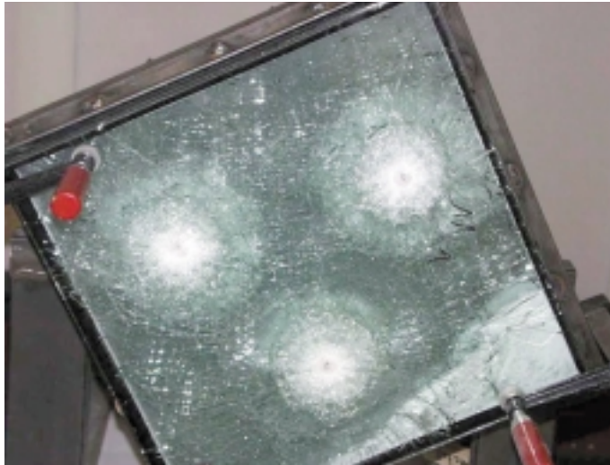
Scheibe nach Standardbeschuß mit Splitterabgang
