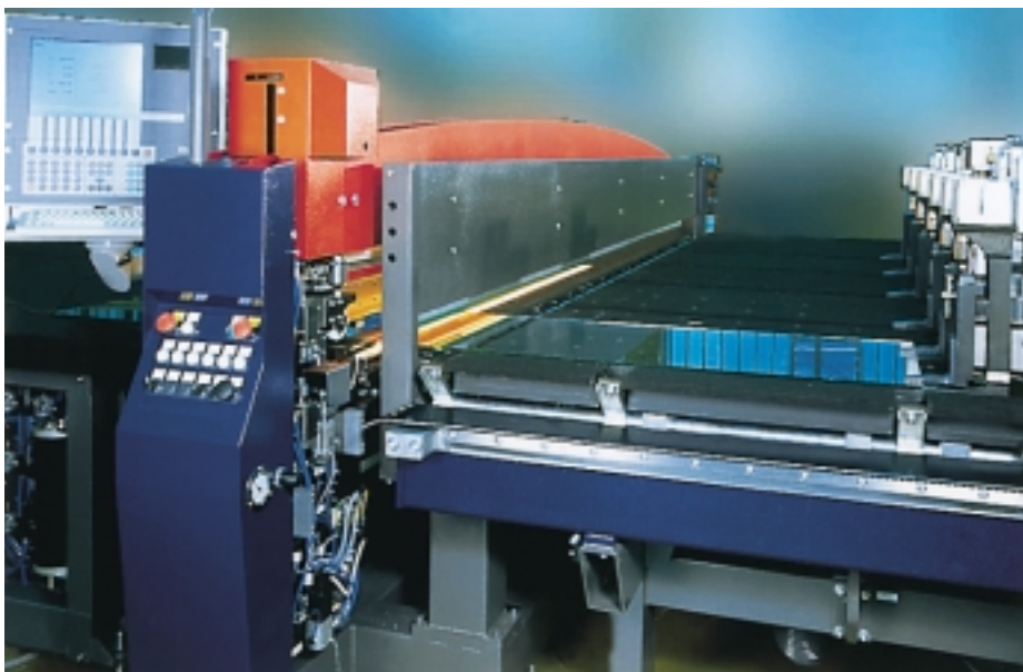
Herzstück der neuen Anlage ist die Schneid- und Trennbrücke mit Doppelschneidkopf und Infrarotheizung
