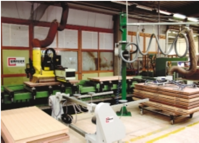
CNC-Anlage für Paneeltür Holz-Alu
