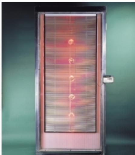
*Die besonderen Bedingungen im hermetisch geschlossenen Raum des Isolierglases erfordern qualitativ hochwertige Komponenten. Die Abbildung zeigt ein Testelement, das auf 100 000 Doppelhübe unter unterschiedlichen klimatischen Bedingungen getestet wird*
