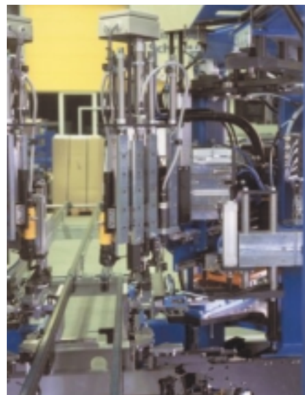
Blick auf den Bearbeitungskopf eines horizontalen Zweikopfverputzautomaten – CNC-gesteuerte Achsen garantieren eine optimale Bearbeitung der Profilelemente, zusätzliche Werkzeuge (optional) gestatten auch die Bearbeitung von Schrägen und Radien Bilder: Stürtz
