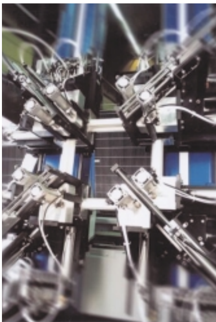
CNC-gesteuerte Achsen bringen die Schweißköpfe diese Vierkopfschweißautomaten exakt an die Gehrungsflächen der Profile
