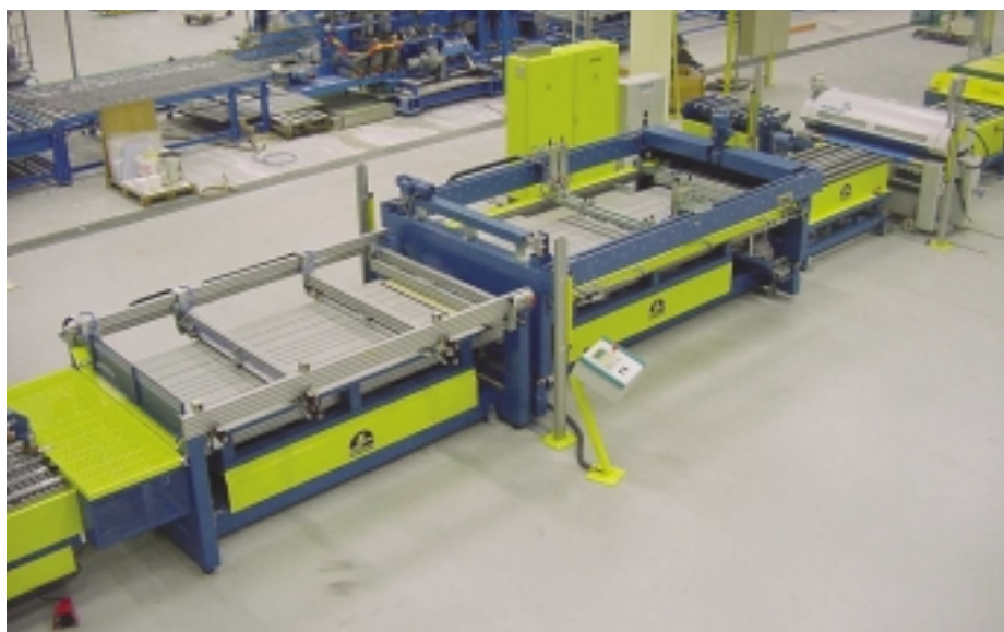
Mit der vollautomatischen Siebdruckanlage „TP“ können Glasscheiben verschiedener Formen und Größen exakt und schnell bedruckt werden
