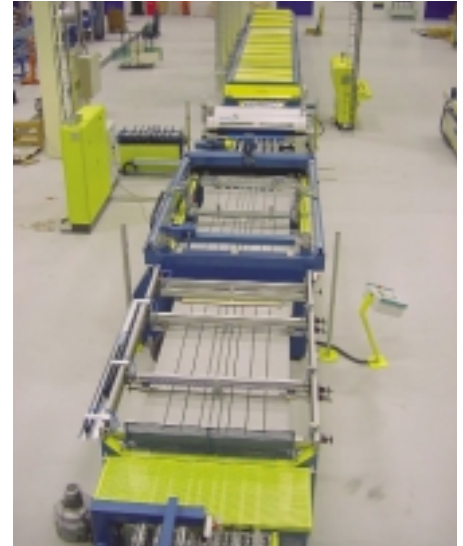
Für die „TP“-Siebdrucklinie wurde ein neuartiges System für einen schnellen Scheibentransport entwickelt
