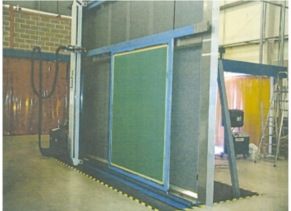
Mit dem „Jetscreen“ werden bei der digitalen Kopierbildübertragung auf Siebdruckschablonen keine Diapositive mehr benötigt
