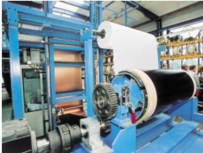
*Die neue Beschichtungsanlage von Interpane Solar vergrößert die Produktionskapazität für das selektive Absorberband „Sunselect“ auf das Dreifache. Damit begegnet das Unternehmen nicht nur mengenmäßig, sondern noch einmal qualitativ den gestiegenen Ansprüchen des Solarmarktes*
