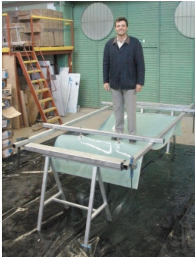
*2,7 × 1,35 m große Platten aus VSG wie diese kommen für das Glasdach der Endesa-Zentrale in Madrid zum Einsatz. Die Ionoplast-Zwischenlage verhindert, daß sich Bruchstücke lösen, obwohl beide Glasscheiben zerbrochen sind. Und sie trägt problemlos das Gewicht eines Menschen, wie Francesco Arbos von Bellapart demonstriert*
