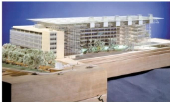
*Das flache Glasdach der neuen Firmenzentrale von Endesa in Madrid hat eine Fläche von 3000 m<sup>2</sup> und wiegt 135 Tonnen. „SentryGlas Plus“ Ionoplast-Zwischenlagen geben dem VSG die notwendige hohe Belastbarkeit und die für Überkopf-Verglasungen geforderte Sicherheit*
