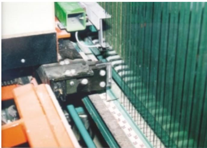
*Der Greifer sorgt für präzisen, schnellen und kontinuierlichen Eintransport der Scheiben*
