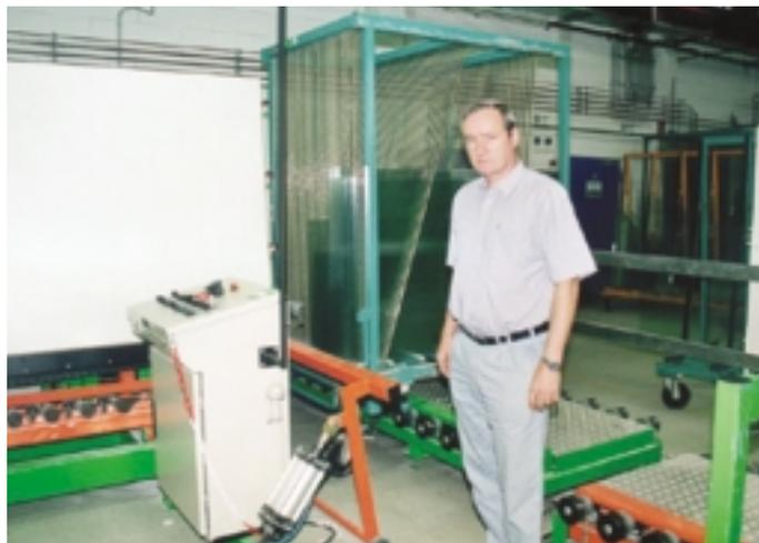
*„Hegla-Glaseinzug“ bei Wolff + Meier: Nach der Einschleusung in das Grundgestell wird der Fächerwagen über die integrierte Hubpalette pneumatisch angehoben und dabei gleichzeitig zentriert; die Pufferstation ist modular aufgebaut und kann nach den Anforderungen des Kunden erweitert werden*
