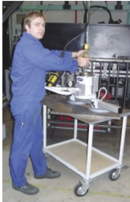
Das Bild zeigt die einfache Installation des neuen, selbstansaugenden Vakuumhebergerätes: Einfach den „Vacumaster Eco“ am Hebezeug aufhängen und schon kann es losgehen Bild: Schmalz
