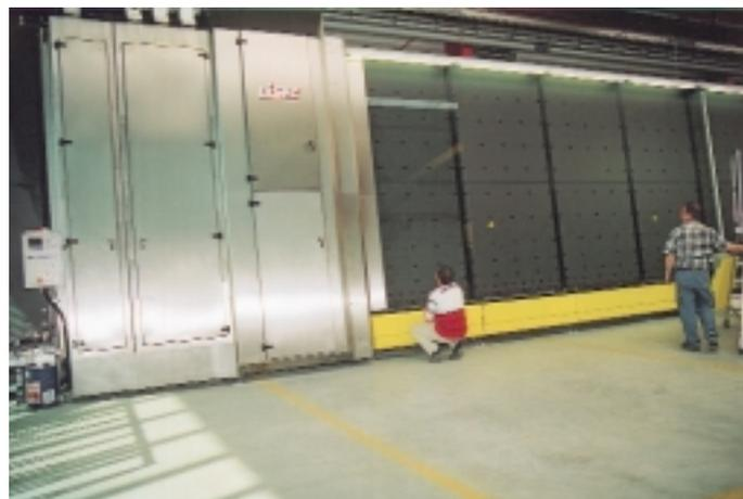
Die z. Z. weltgrößte, weitgehend automatisierte Isolierglas-Fertigungslinie, hier können Scheiben bis zur Größe von  $3,21\text{ m} \times 6\text{ m}$  gefertigt werden
