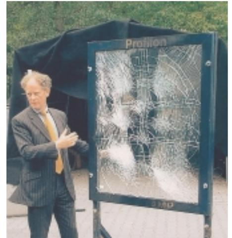
Bei den Sicherheitsseminaren von Haverkamp werden z. B. durchschuß- und einbruchhemmende Konstruktionen unter realistischen Bedingungen getestet
