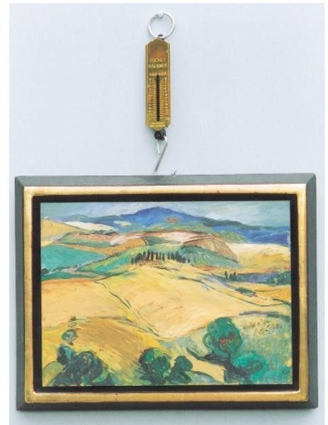
Bild 2: Dieses kleinformatige Bild (Öl auf Leinwand), eingefasst von einem Schattenfugenrahmen, wiegt nur zirka 1 kg. Bei einer Aufhängung mit Bilderdraht im Winkel von  $15^\circ$  (s. Bild 4) verursacht das Bildgewicht die Zugkraft von 1,93 kg beidseitig auf den Draht und seine Verankerung
