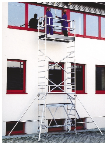
Ab einer Höhe von 4,8 m sichern zusätzliche Dreiecksausleger den Stand der Günzburger Gerüste
