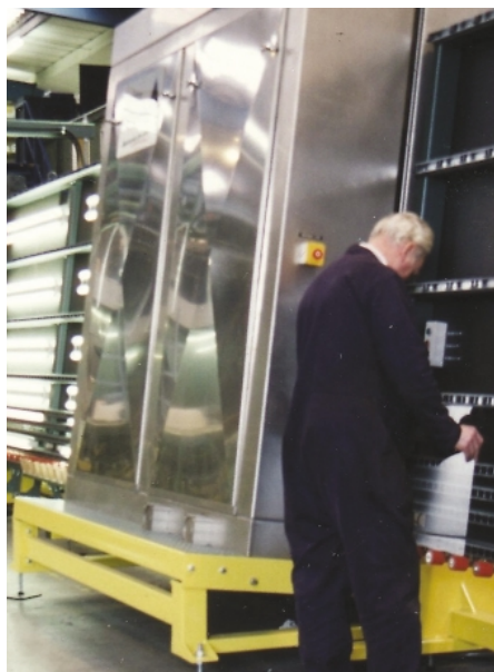
Die „AIS-HWPRO-10“ von Ashton Industrial ist eine sehr schnelle und kompakte Einheit für die Reinigung von Glas nach der Kantenbearbeitung und vor dem Härten Bild: Ashton Industrial
