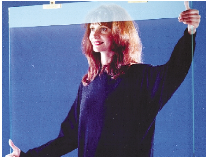
Bild 1: Mehr Durchblick durch Antireflexbeschichtung. Der untere Teil der Glasscheibe ist mit dem neuen Verfahren entspiegelt, dem oberen Streifen fehlt die Beschichtung (Bild: ISC)
