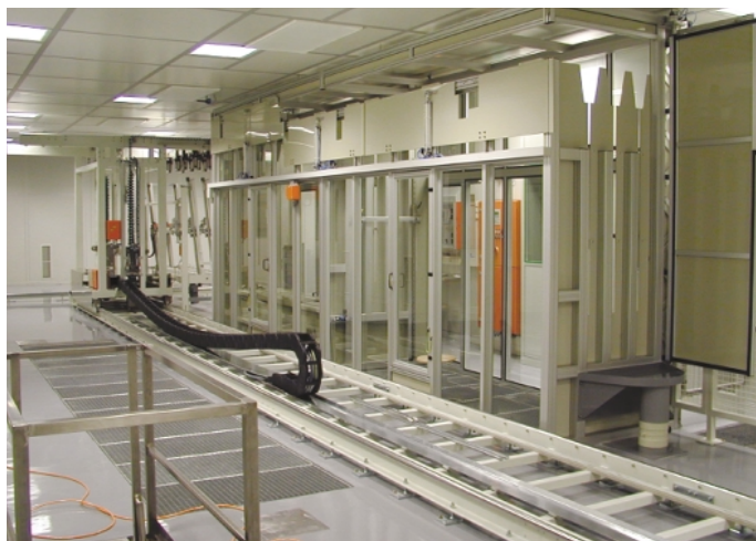
Bild 5: Herstellung von beschichtetem Antireflexglas-Beschichtungsanlage
