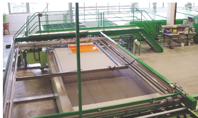
Bild 4: Für kurze Nebenzeiten und damit eine hohe Flexibilität sorgt die begehbrücke, die den bequemen Wechsel der Rakelgummi von oben ermöglicht
