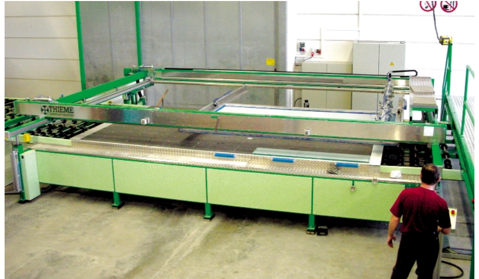
Bild 1: Stabile Siebdruckmaschine für großflächige, bis 350 kg schwere, 3 bis 19 mm dicke Glasscheiben
