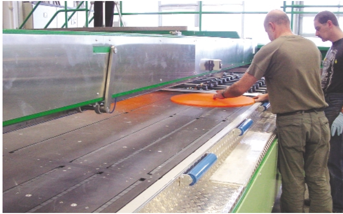
Bild 2: Einzelstücke legt das Personal manuell auf, die Siebdruckmaschine arbeitet halbautomatisch
