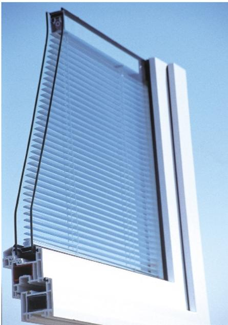
Der Vorteil von „ScreenLine“, einer Sonnenschutz-Jalousie im Isolierglas, liegt darin, daß sie optimal vor Wittereinflüssen und Schmutz geschützt wird. Durch eine magnetische Bewegungsübertragung erfolgt das Heben und Senken über eine magnetische Koppelung, ohne Schwachstelle bei der Dichtigkeit der Isolierglasscheibe, da diese nicht durchbohrt wird
