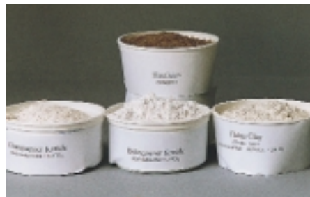
Kreiden und Hautleim gehören neben Poliment zu den wichtigsten Werkstoffen des Vergolders
