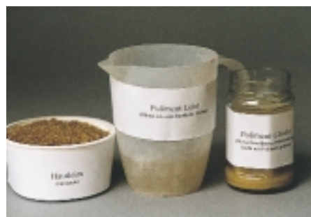
Aus den Graupeln des Hautleims bereitet der Vergolder den Poliment-Leim und die Poliment-Lösche zu
