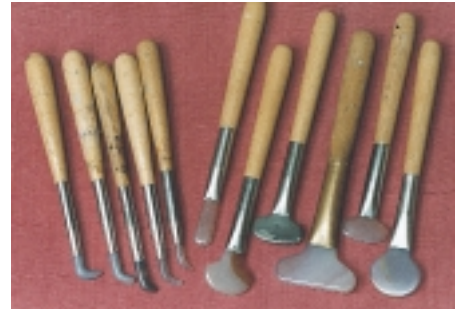
Mit Polierachaten unterschiedlicher Form bringt der Vergolder das hauchdünne Gold auf einer Rahmenoberfläche auf Hochglanz
