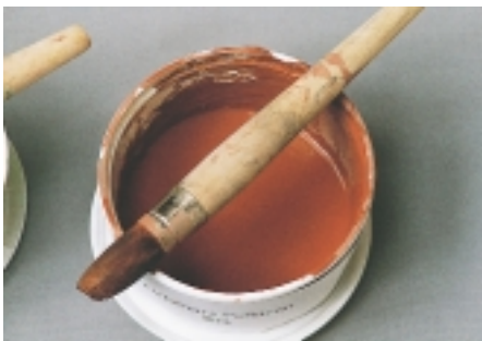
Poliment wird vor dem Aufstrich auf die kreidegrundierte Rahmenoberfläche mit wäßriger Hautleimlösung versetzt. Die Leimung darf weder zu schwach, noch zu stark sein
