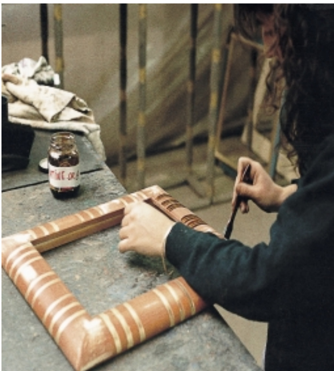
Poliment wird vor dem Aufstrich auf die kreidegrundierte Rahmenoberfläche mit wäßriger Hautleimlösung versetzt. Die Leimung darf weder zu schwach, noch zu stark sein
