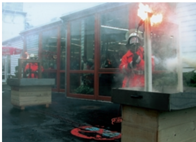
Bei einer Live-Vorführung demonstrierte ein Holzfenster (links) eindrucksvoll seine guten Eigenschaften im Brandfall – z. B. durch eine wesentlich geringere Rauchentwicklung als bei einem Kunststofffenster (rechts)
