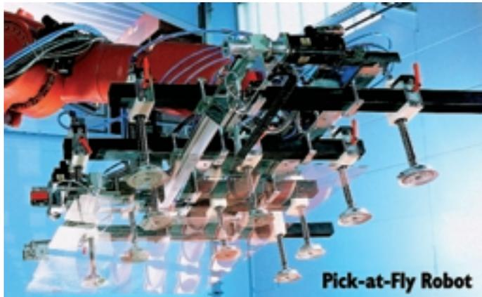
Bild 2: Der „Pick at Fly“ Roboter ermöglicht eine wirtschaftliche Ressourcen-Nutzung bei gleichzeitiger Verringerung von Glasverlusten
