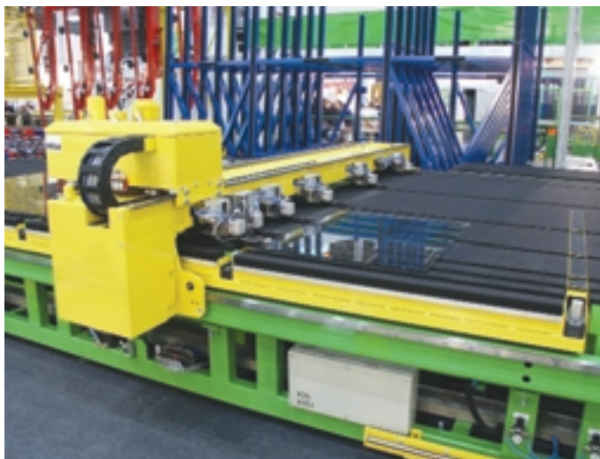
Bild 4: Positionierbrücke mit Doppelgreifern
