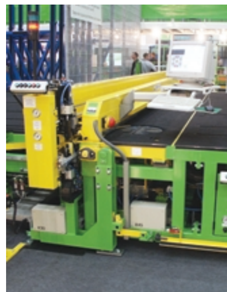
Bild 5: Brücke mit Doppelschneidkopf und hochpräzisen Linearführungen
