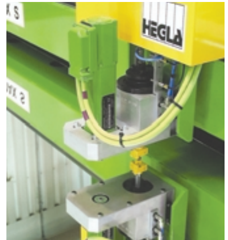
Bild 7: Hegla-Präzisions-Schneidkopf Bilder: Hegla
