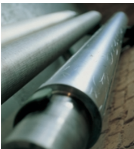
Bild 3: Gußglas ist häufig mit Ornamenten versehen, die rechte Walze dient zur Herstellung solcher, geprägter Verzierungen
