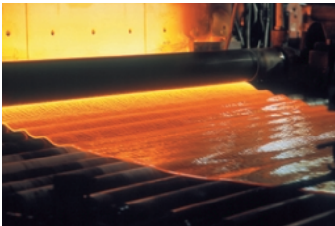
Bild 2: Bei der Gußglasherstellung läuft die heiße Glasmasse zwischen zwei wassergekühlten Walzen hindurch
