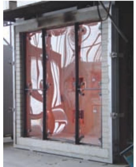
Die punktgehaltene Verglasung von Wuppermann Staba hat in Tests eine sehr gute Brandwiderstandsfähigkeit gezeigt
