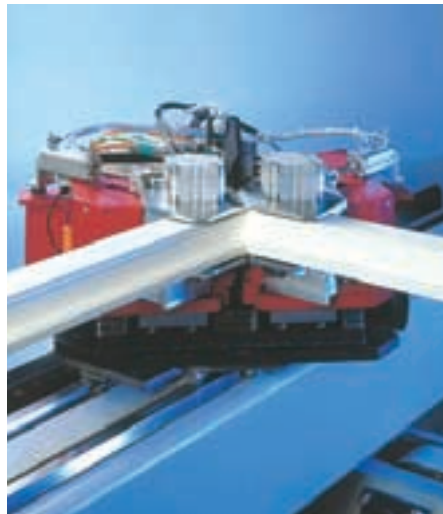
Die kürzlich fertiggestellte Reibschweißmaschine „Emotion 4 “ soll in der Lage sein, die Wirtschaftlichkeit der gesamten Prozeßkette im Fensterbau deutlich zu verbessern Bilder: M-O-SYS
