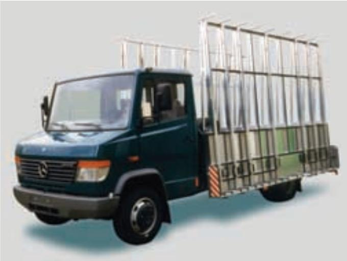
Bild 4: Ideales Verteilerfahrzeug im Nahbereich. Die Reffs sind speziell für große Scheiben geeignet
