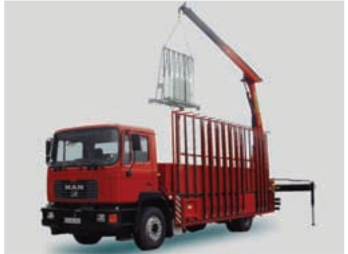
Bild 5: Lkw 14 t – Verteilerfahrzeug mit Ladekran und 6000 mm Aufbau­länge – Nutzlast von ca. 6 t
